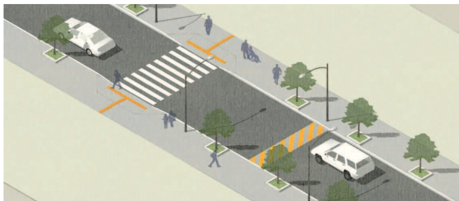
Figura 7 – Deflexões Transversais: Lombadas
