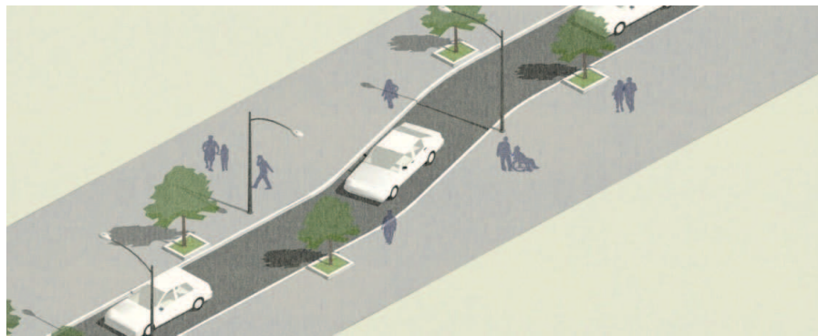
Figura 11 – Deflexões Horizontais: Chicanas
