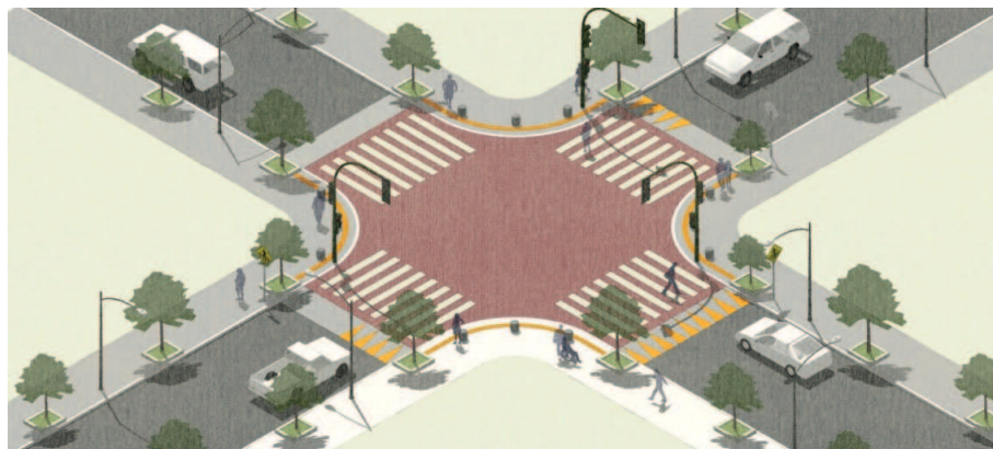
Figura 8 – Deflexões Transversais: Interseção elevada ou Platô
