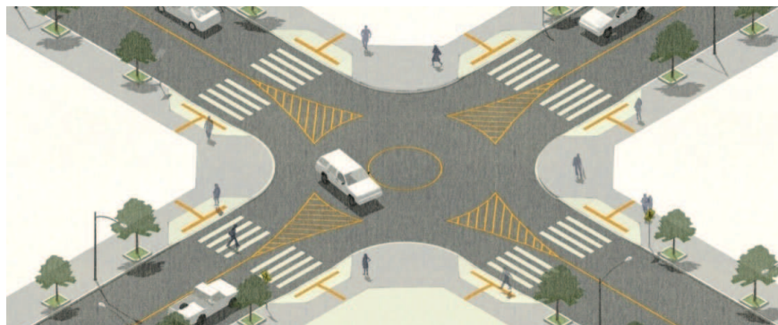
Figura 12 – Deflexões Horizontais: Mini Rótulas ou Minirrotatórias
