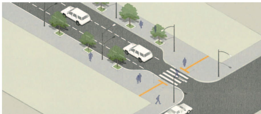
Figura 10 – Deflexões Horizontais: Avanço de Calçada
