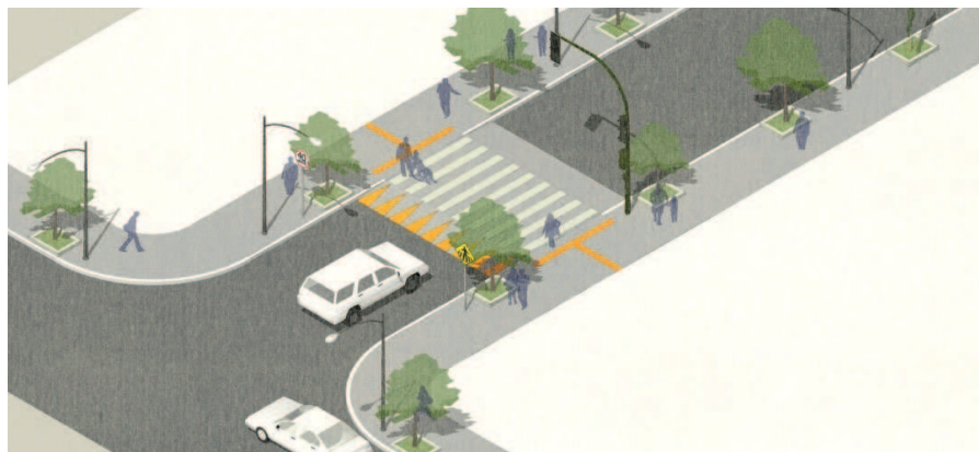
Figura 8 – Deflexões Transversais: Travessias Elevadas
